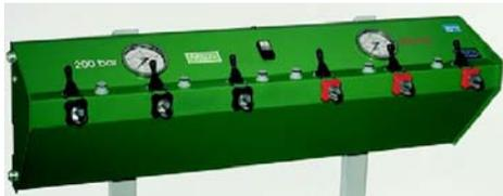
На стационарном компрессоре возможен удобный монтаж одновременно нескольких воздушных баллонов на наполнительную панель.
