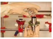
При испытаниях на проникновение проверяется время проникновения химикалий сквозь материал комбинезона. VAUTEX ELITE выдерживает даже толуол, 96% серную кислоту, хлор или аммиак свыше 8 часов и отвечает почти всем нормам высшего класса.
