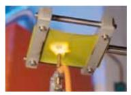
Чрезывчайно высока устойчивость против воздействия жары и кратковременного открытого пламени. Температура воздействующего на материал пламени превышает 800°C. VAUTEX ELITE выдерживает и гаснет непосредственно сразу после отсечения пламени.
