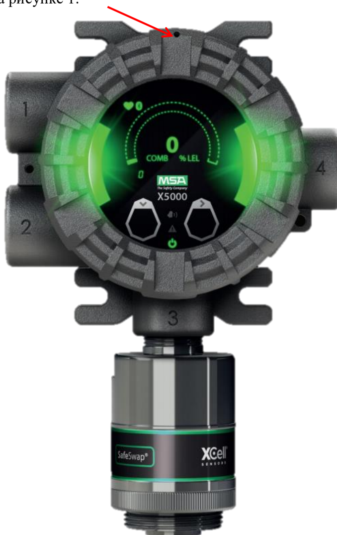
Рисунок 1 - Общий вид газоанализаторов ULTIMA X5000 с одним датчиком XCell Digital Sensor и схема пломбирования корпуса от несанкционированного доступа (место пломбирования указано стрелкой)
