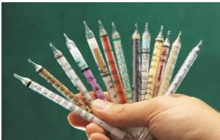
Рис. 1. Трубки индикаторные AUER, входящие в состав газоанализаторов.
